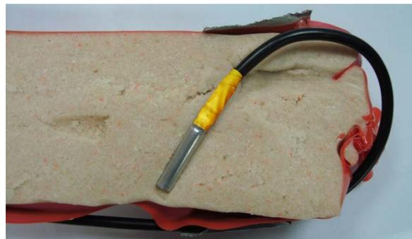
Abb. 1 und 2: Seitliche Anbringung der Sprengkapsel Nr. 8 **FALSCH!**
